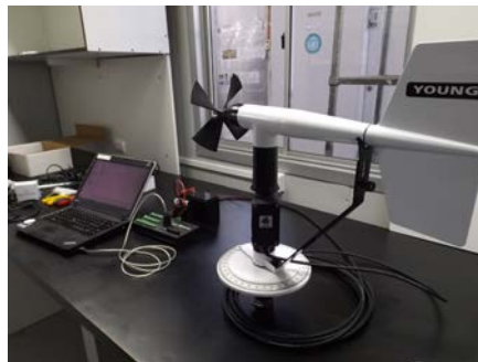
Figura 34: ángulo de torque para calibración de anemómetro.
