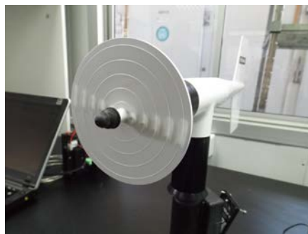
Figura 35: Disco de torque para la calibración de la hélice del monitor de viento.
